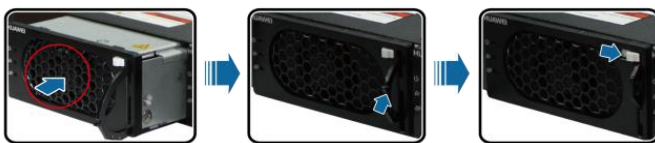
图6 安装新PSU模块
